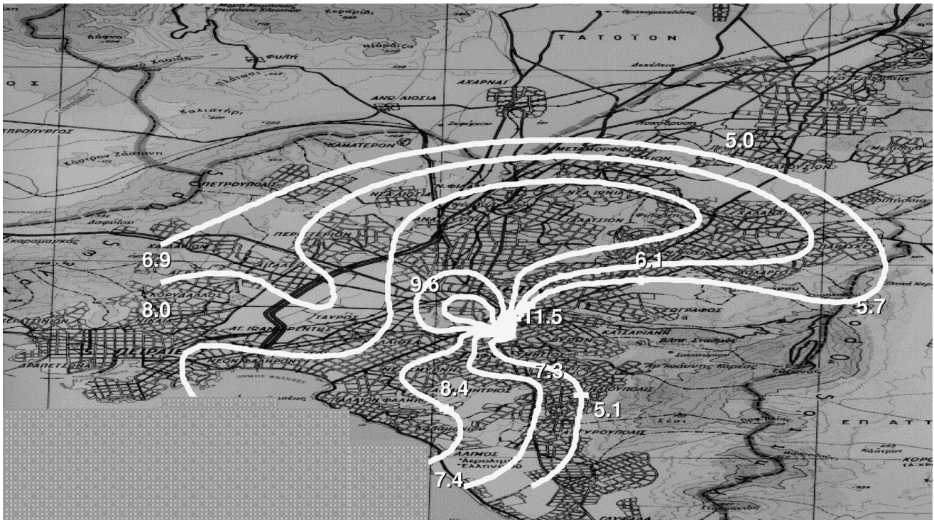
Εικόνα 43: Διαφοροποίηση της κατανάλωσης ηλεκτρικής ενέργειας στην Αθήνα για ψύξη ( \text{KWh}/\text{m}^2/\text{μήνα} ) σε συνάρτηση με την απόσταση από το κέντρο της πόλης.
