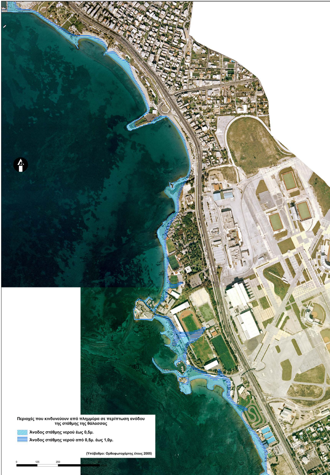
Σχήμα 33: Κατακλυσμός Χερσαίων Εδαφών Λόγω της Ανόδου της Στάθμης της Θάλασσας (με Ανοιχτό Γαλάζιο Χρώμα για Άνοδο κατά 0.5 Μέτρα και με Γραμμοσκιασμένο Μπλε για Άνοδο από 0,5 έως 1 Μέτρο) για το Παράκτιο Μέτωπο Αγίου Κοσμά
